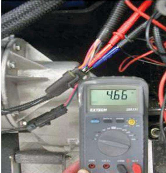
Fig. 20 Speed Sensor
