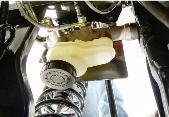
Le réservoir du liquide de frein se trouve sous le capot au niveau de la roue avant côté conducteur. Retirez le panneau du capot pour accéder au réservoir. Outre l'intervalle d'entretien périodique pour le changement du liquide de frein (page 62), celui-ci doit également être changé dans les conditions suivantes :
