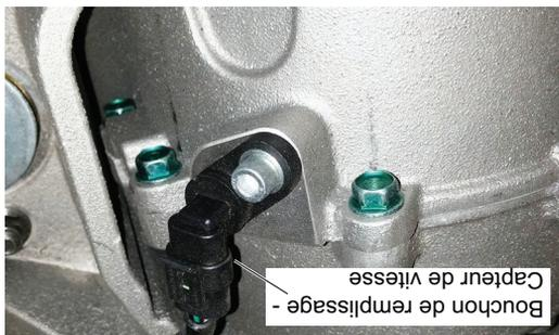
6. Retirez le capteur de vitesse du véhicule.
