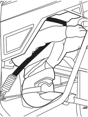
1. Tirez sur la plaque de verrouillage de la ceinture de sécurité vers le bas et sur la poitrine vers la boucle sur le bord intérieur du siège.
