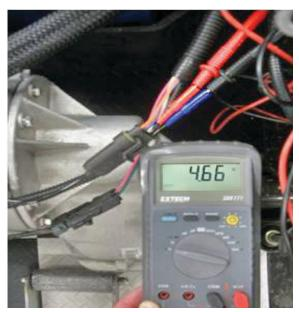
Fig. 20 Speed Sensor
